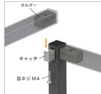
パイプに固定したホルダーとキャッチが噛み合い、ネジで締め込むことにより、パイプ同士を強固に締結します。
